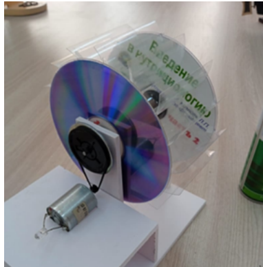
Рисунок 2 – Модель-мини ГЭС из подручных средств
