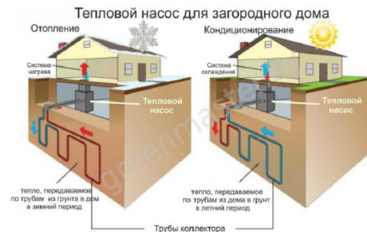
Рисунок 1 – Схема геотермальной установки
